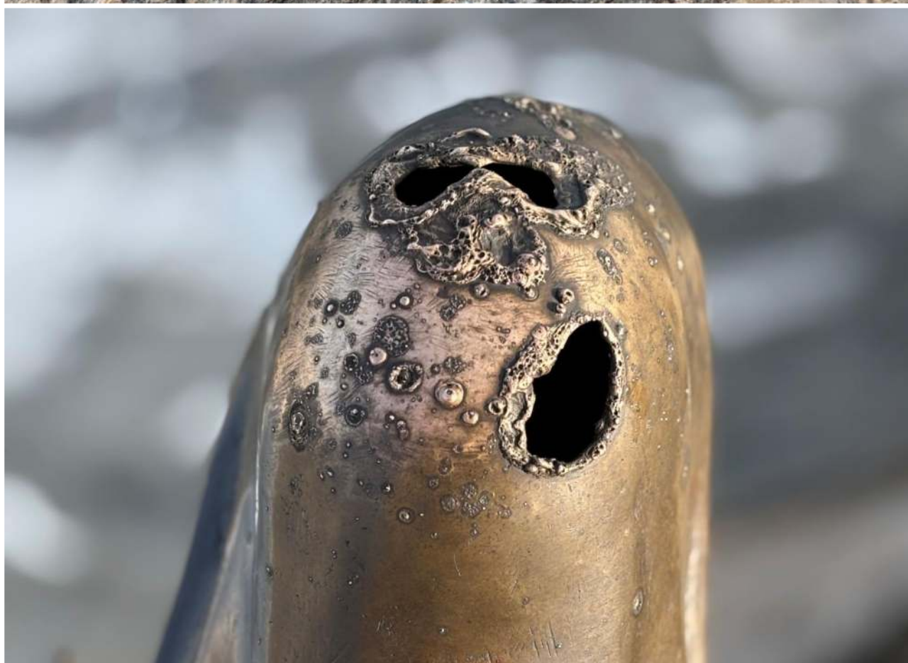
Pav. 29 Audros metu ant Dent du Géant būti nepatariama. Viršus: nuo žaibo iškrovos išsilydęs boltas. Apačia: žaibo iškrovos neišvengė ir Dent du Géant Marijos viršugalvis. (Linas Smalakys, 2025-08-12)
